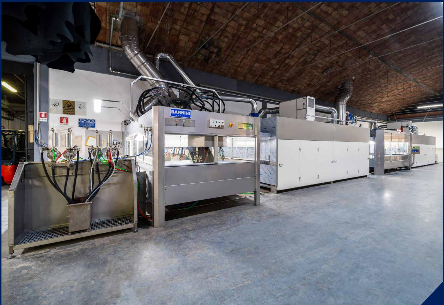
La cabina di verniciatura automatica con meccanica a piste parallele rappresenta il sistema più efficace ed efficiente per la verniciatura automatica delle pelli. La semplicità e la robustezza della meccanica assicurano un'elevata affidabilità con prestazioni superiori rispetto a qualsiasi altro sistema applicativo a spruzzo.
