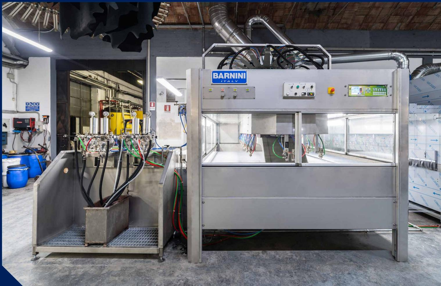
La cabine de pulvérisation automatique avec mécanique à pistes parallèles est le système le plus efficace et le plus effective pour le peinture automatique de la peau. La simplicité et la solidité de la mécanique garantissent une grande fiabilité et des performances supérieures à celles de tout autre système d'application par pulvérisation.
