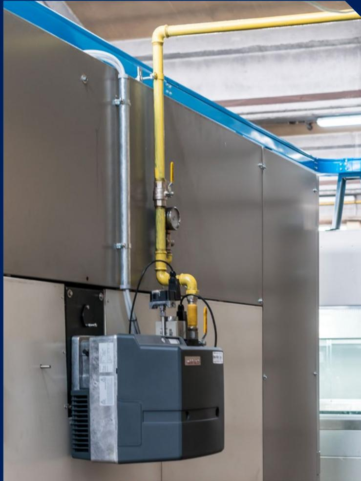
烘道型号TB2是当今最先进的皮革干燥机械。它独特的内部空气循环系统和高度的绝缘性，保证了极高的干燥效率。烘道可以采用不同的能源功能，例如蒸汽、热水、过热水、导热油或沼气或液化石油气燃烧器等。不同尺寸的铰接式烘道可由多个元件组成，具有一级或多级温度控制，并加入自动喷涂或涂饰生产线中。
